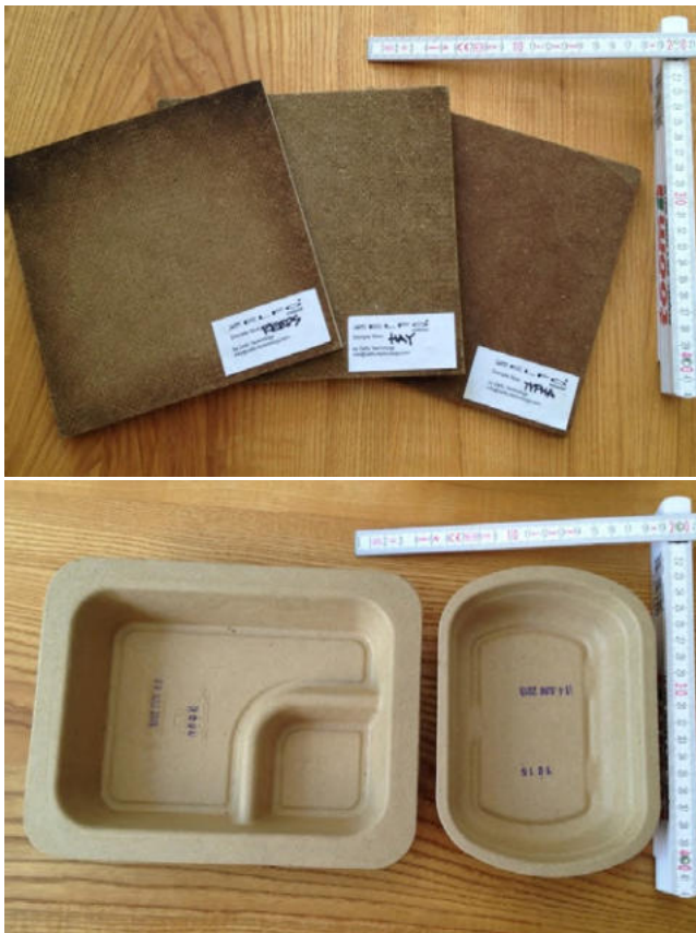
Фото 17 і 18: Будівельні плити (ліворуч) та одноразовий посуд (праворуч), пресований з неспецифічної біомаси з вологих луків (Віхтманн)
